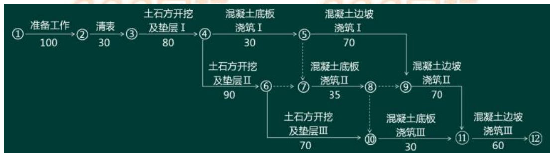
图 2 施工进度计划图（单位：天）
