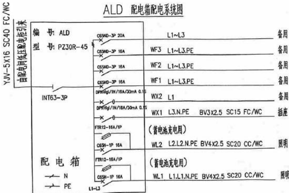
图6. II.3 配电箱系统接线图、设备材料表
