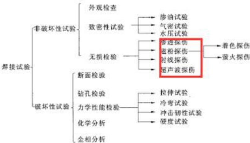
图 4-3-2 焊缝质量检验方法
